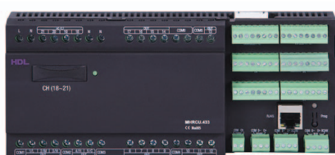
Sdružený modul HDL-MHRCU-433 pro úplné řízení hotelového pokoje
